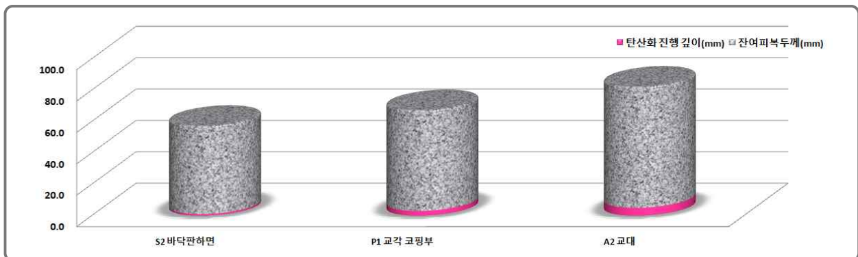
[그림 4.2.3] 탄산화깊이 및 잔여피복두께 측정결과
